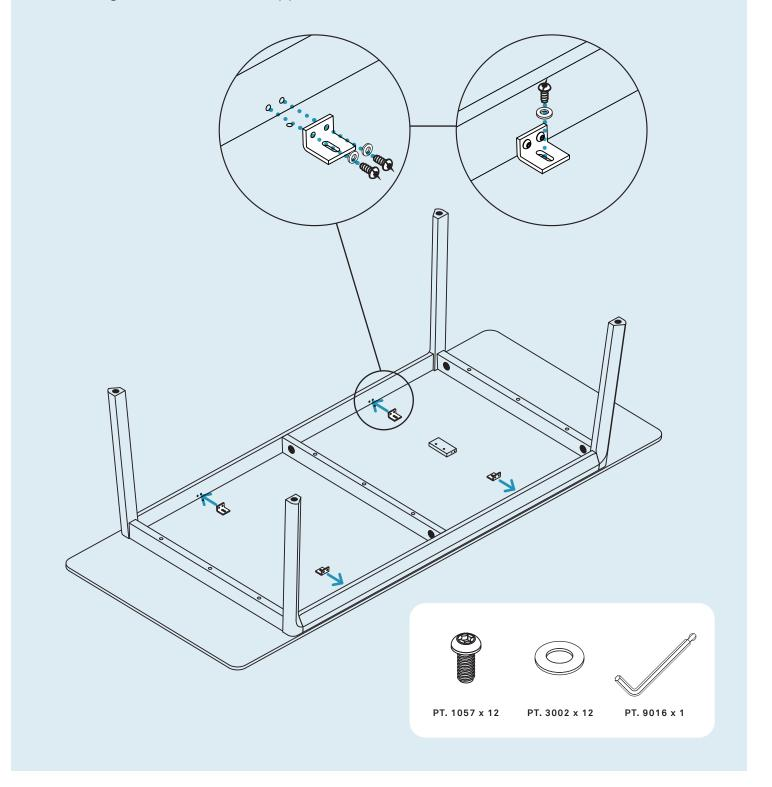
FINISH TIGHTENING THE SUPPORT RAILS.
